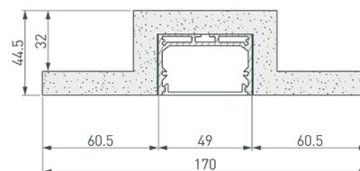
Гипсокартонный модуль серии LINE со встроенным алюминиевым профилем SL-LINE-4932.
