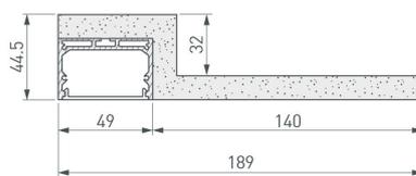
Гипсокартонный модуль серии EDGE со встроенным алюминиевым профилем SL-LINE-4932.
