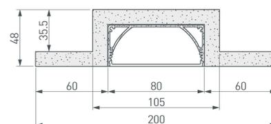
Гипсокартонный модуль серии LINE со встроенным алюминиевым профилем ALU-POWER-W80N.
