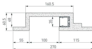
Гипсокартонный модуль серии BAY со встроенным алюминиевым профилем SL-LINE-3535.
