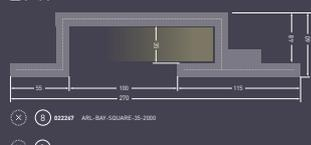
Гипсокартонный модуль **Arlight** представляет собой заготовку из гипсокартона с уже встроенным в нее профилем для светодиодных лент.
