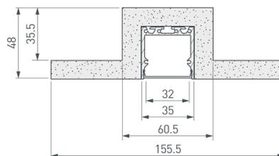
Гипсокартонный модуль серии LINE со встроенным алюминиевым профилем SL-LINE-3535.
