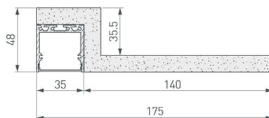
Гипсокартонный модуль серии EDGE со встроенным алюминиевым профилем SL-LINE-3535.
