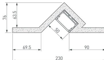
Гипсокартонный модуль серии SLOT со встроенным алюминиевым профилем SL-LINE-4932.
