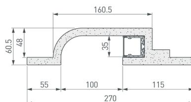
Гипсокартонный модуль серии BAY со встроенным алюминиевым профилем.
