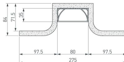
Гипсокартонный модуль серии SLOT со встроенным алюминиевым профилем ALU-POWER-W80N.
